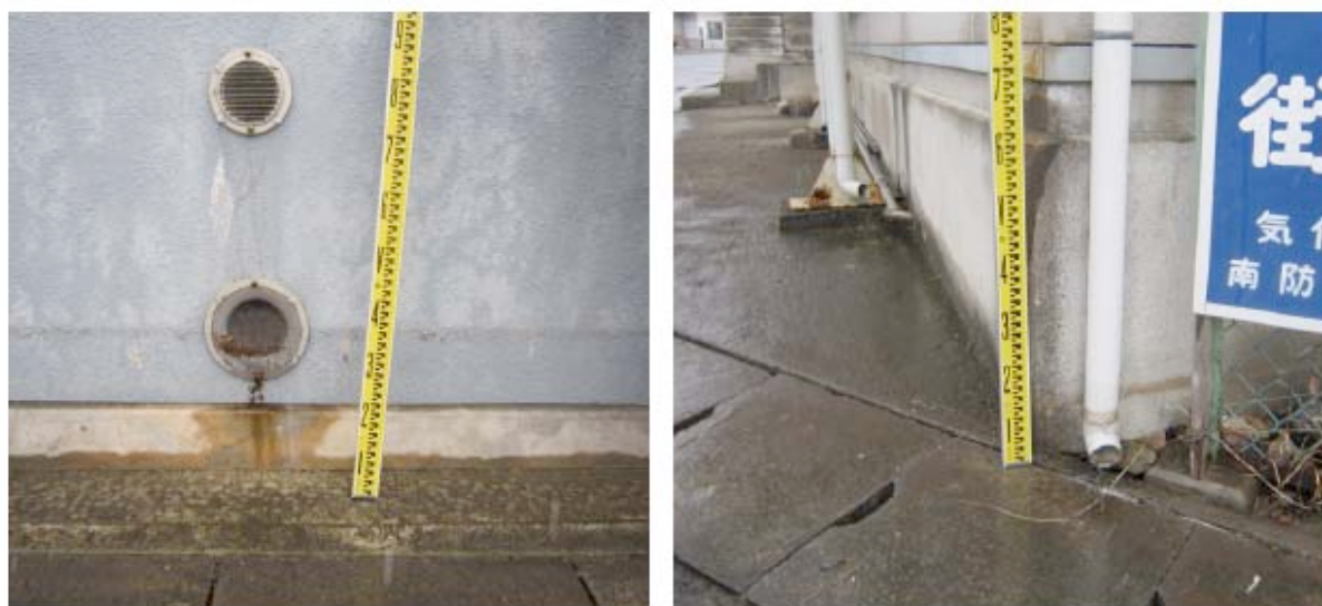
写真 8 中央公民館付近での浸水高さの測定
