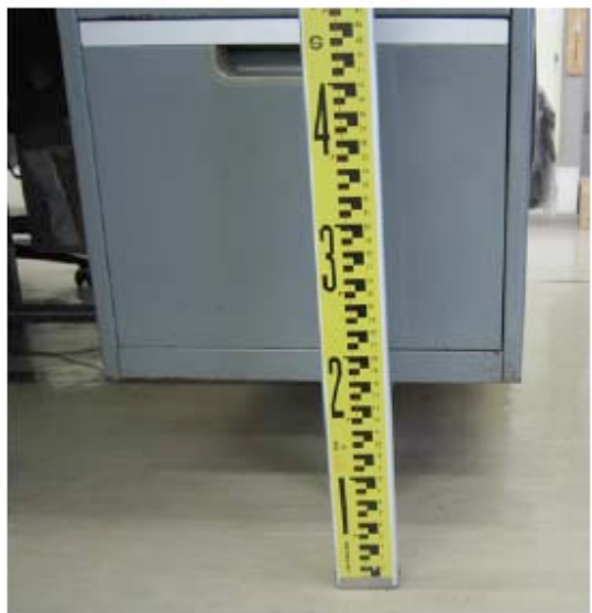
写真3 気仙沼商会の建物内 (上：聞き取りの様子，下：浸水高さの測定)
